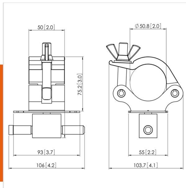
PUC 1090 - адаптер для стропильной фермы, является частью модульной системы Connect-it, при помощи которой Вы можете создать индивидуальное решение для потолочного монтажа средних и больших дисплеев.
