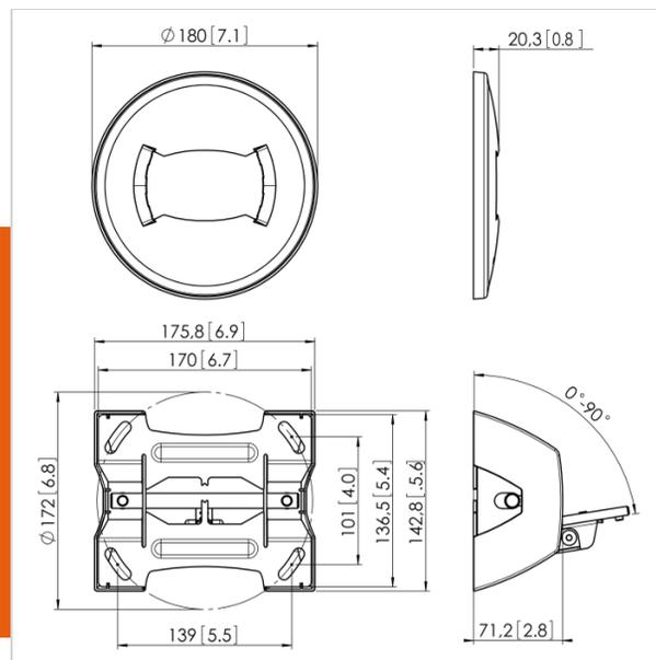
PUC 1070 - потолочная пластина, является частью модульной системы Connect-it, при помощи которой Вы можете создать индивидуальное решение для потолочного монтажа средних и больших дисплеев.
