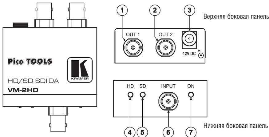
Рис. 1. Усилитель-распределитель VM-2HD
